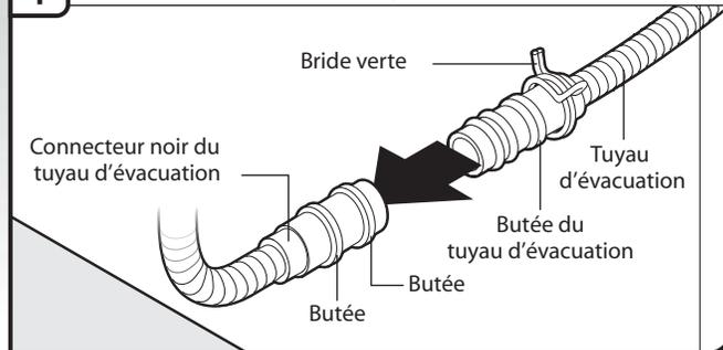
Placer une serviette sous le tuyau d'évacuation pour récupérer toute quantité d'eau qui peut s'écouler du tuyau. Placer la bride de tuyau verte (petite bride) sur l'extrémité de petit diamètre du tuyau d'évacuation. Enfoncer le tuyau d'évacuation dans le connecteur noir jusqu'au point de butée.
